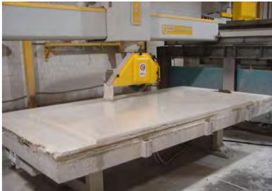
FIGURA 5 EJECUTE LAS CUCHILLAS Y LAS HERRAMIENTAS A ALTAS RPM E INUNDE LA LOSA CON AGUA EN TODO
