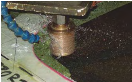
Figura 6 Enrutamiento de las aberturas del fregadero IceStone
