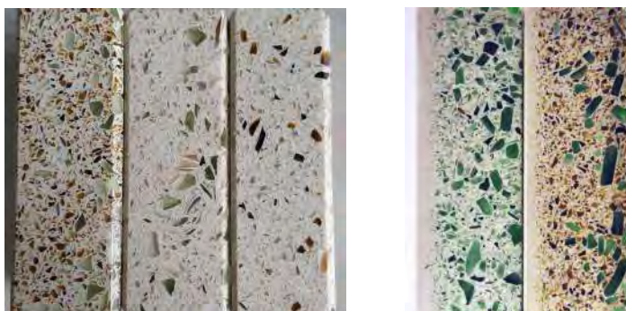
Figura 2 Ejemplo de segregación de vidrio aceptable a la izquierda e segregación de vidrio inaceptable a la derecha.
